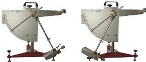
滑度测试仪根据 Izod 原理制成。由一个管状摆臂构成的摆锤围绕着一个垂直支柱上的轴心旋转。在管状摆臂的一端装有一个附有橡胶滑片的锤头。从水平位置释放摆锤，它将以一个恒定的速度擦过试样的表面。锤头擦过试样后滑动的距离取决于试样表面的摩擦。
